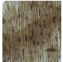
Lámina delgada de la madera del brazo derecho. Imagen obtenida con microscopía óptica con fuente de luz visible
