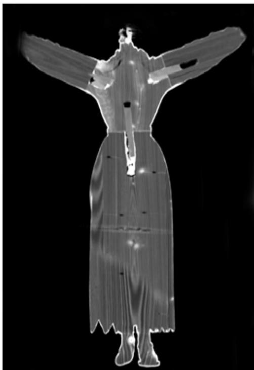
Corte coronal donde se observa las uniones de los brazos y parte inferior con espigas de madera al torso. Se observa una discontinuidad en la cintura.
